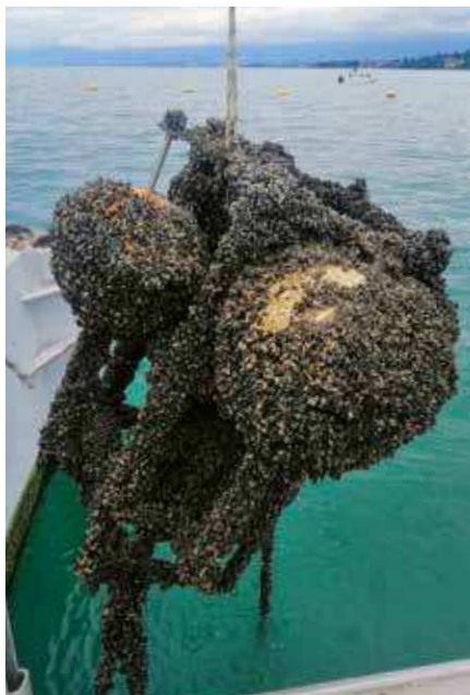
Un instrument de mesure scientifique de la plateforme scientifique LÉXPLORE, ancrée au large de Pully, entièrement colonisé par la moule quagga après une année d'immersion dans le Léman à une profondeur de 8 mètres. (LÉXPLORE/SÉBASTIEN LAVANCHY)
